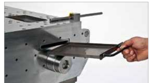
Schublade zum Auffangen vom Zunder
