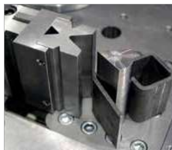
Biegedorn für enges Biegen
