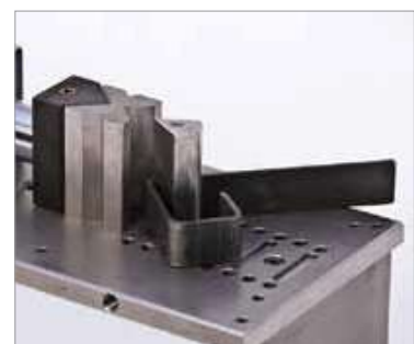
Enges Biegen um den Biegedorn
